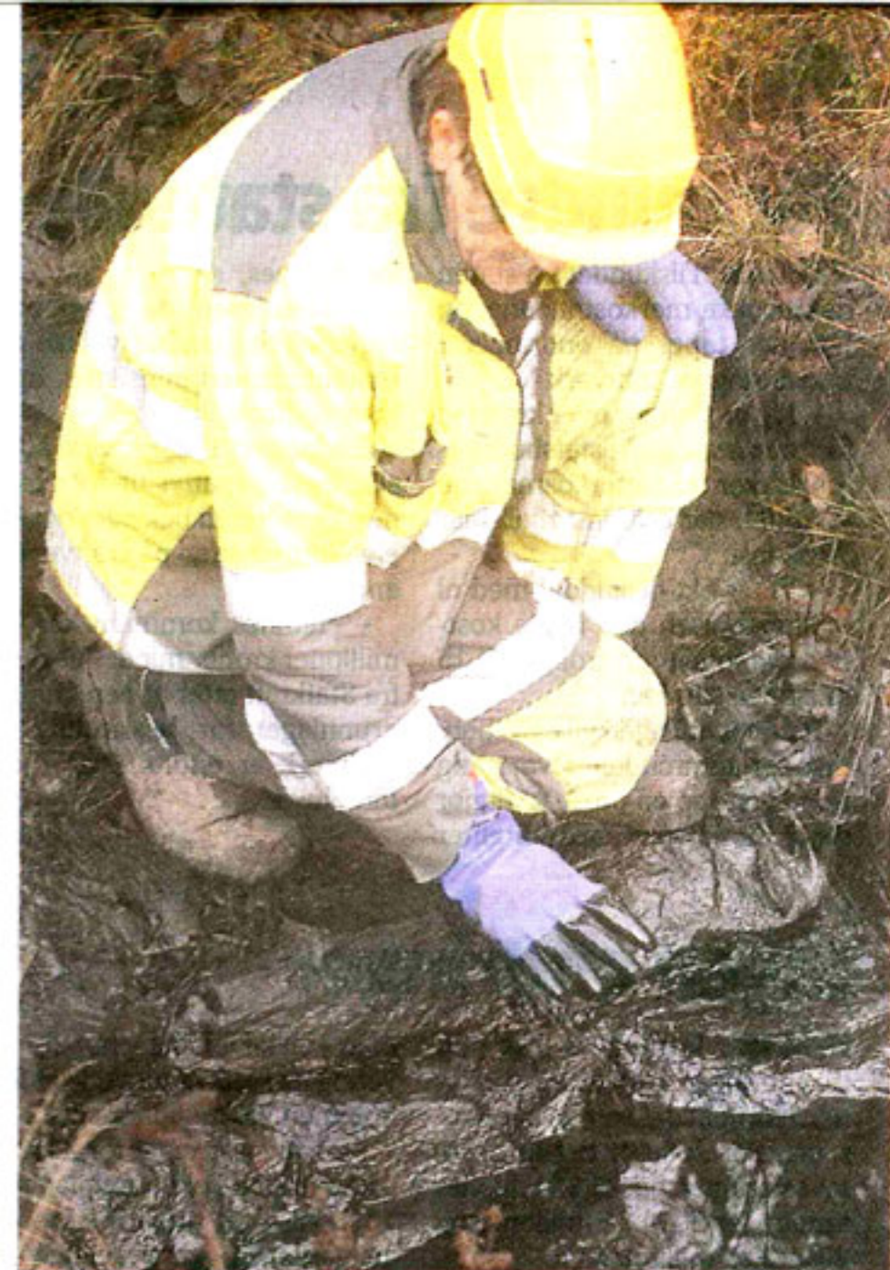
UTSLIPP: Oljen som ble oppdaget av Jernbaneverkets folk er tyktflytende og lukter som brukt motorolje. Foto: Geir Veia
